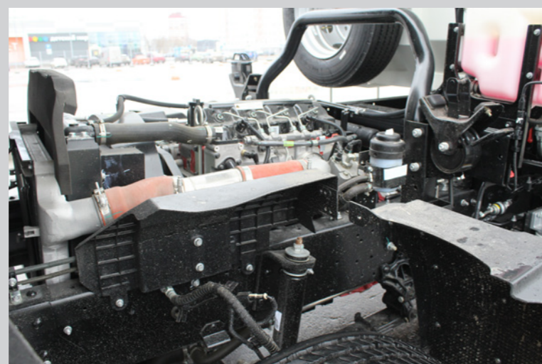
Лицензионный двигатель JAC-Cummins B4.5 EV210 зарекомендовал себя неплохо, доступ для его обслуживания удобный благодаря тому, что кабина откидывается на большой угол. Этот мотор путешествует и перевоплощается не менее, чем в дюжине грузовиков разных марок и моделей!
