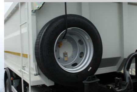
Запасное колесо оснащено механизмом подъёма и опускания
