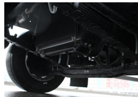
Трансмиссионная перспектива спереди и сзади, беззащитный радиатор, хотя и с противомоскитной сеткой, и оптимально установленные тормозные камеры
