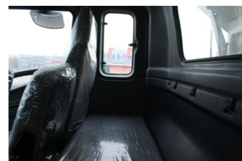
Зазоры между панелями ровные и крепёж нигде не торчит, не пожадничали китайцы и на утепление и шумоизоляцию кабины
