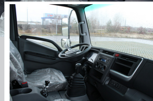
Панель приборов: шкалы читаются вполне приемлемо, богатейший набор контрольных ламп предупредит водителя о снижении требуемого уровня всех без исключения технических жидкостей и моторного масла, падении давления в пневмосистеме, подключении КОМ, и других подконтрольных водителю ситуациях
