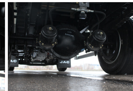
Трансмиссионная перспектива спереди и сзади, беззащитный радиатор, хотя и с противомоскитной сеткой, и оптимально установленные тормозные камеры
