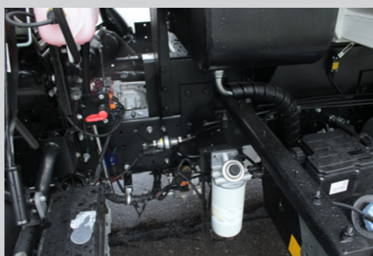
Топливный фильтр-сепаратор с подогревом, налицо подготовка к российскому рынку.
