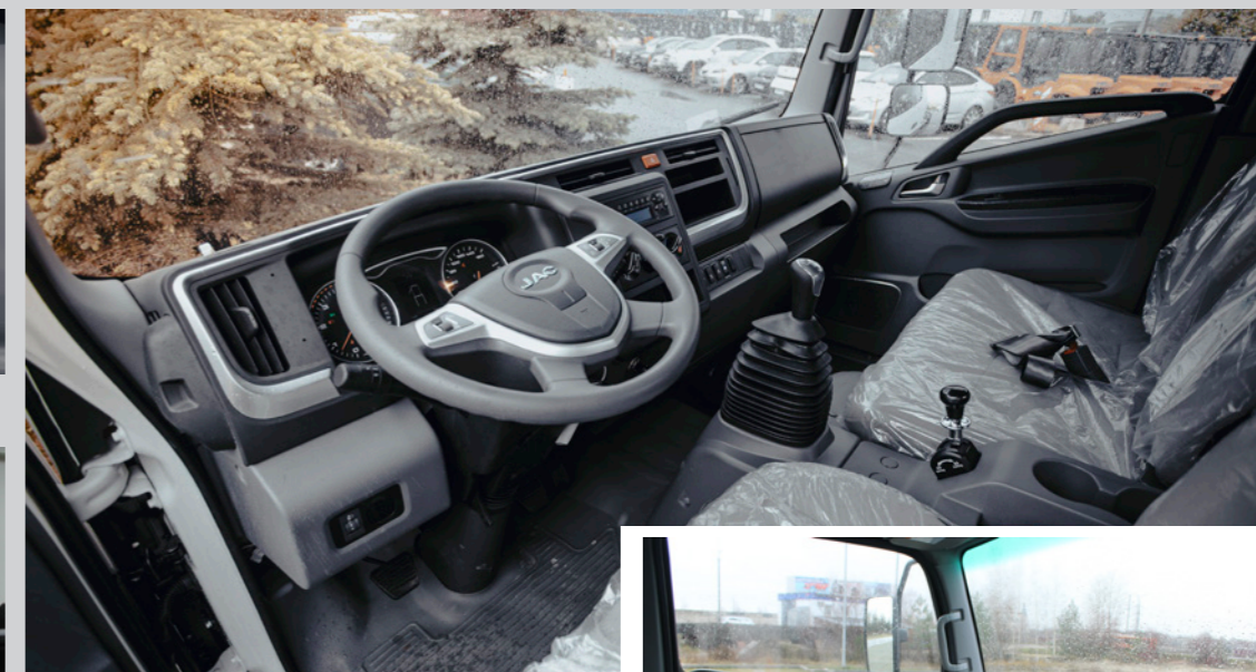
Панель приборов: шкалы читаются вполне приемлемо, богатейший набор контрольных ламп предупредит водителя о снижении требуемого уровня всех без исключения технических жидкостей и моторного масла, падении давления в пневмосистеме, подключении КОМ, и других подконтрольных водителю ситуациях
